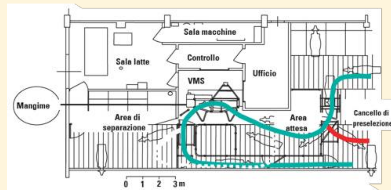
● Il percorso degli animali attorno all'Ams. In rosso il percorso dei capi che non devono essere munti, in verde quello delle bovine da mungere.
